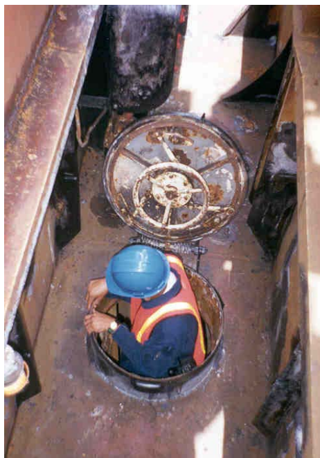
Foto 15.10. - La inspección del vapor comienza con el chequeo de cada compartimiento de carga
